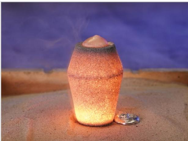
Abb. 4: Konstantes Abbrennen des FEEDEX NF1 Speisers
