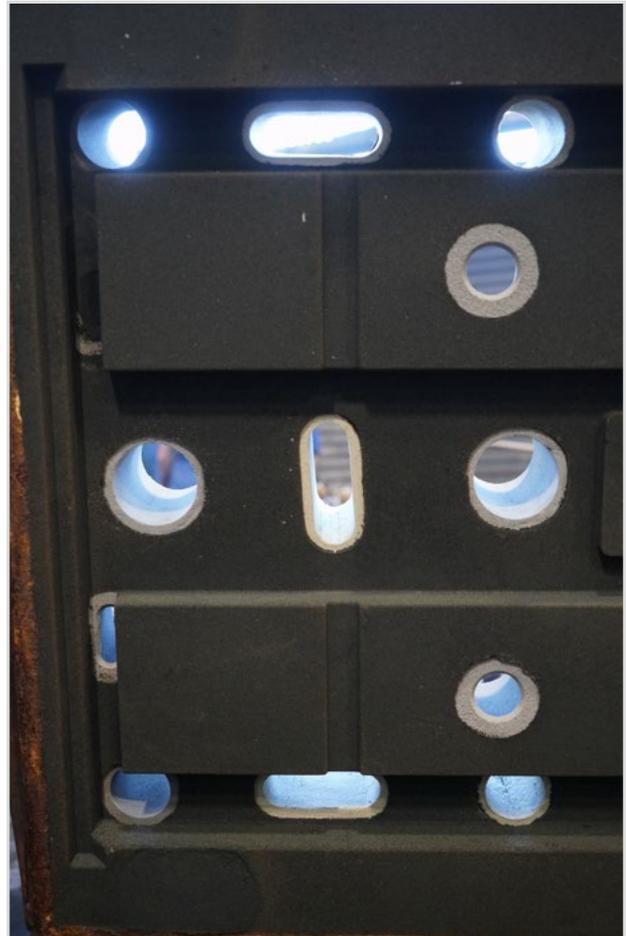
Abb. 2: Exotherme und isolierende Speiser positioniert im Formkasten
