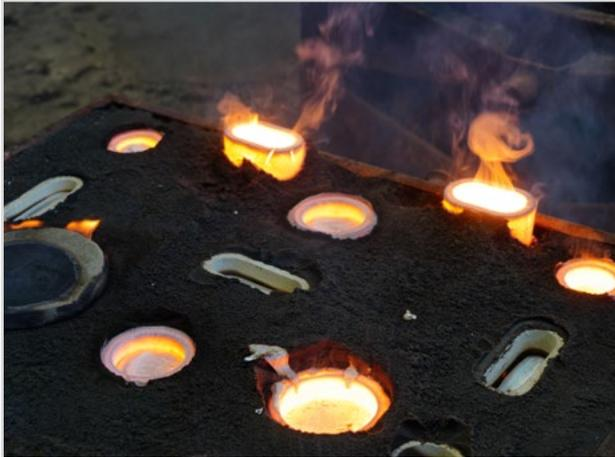
Abb. 3: Deutlich erkennbare exotherme Reaktion des FEEDEX NF1 Speisers
